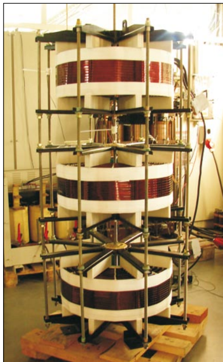
Rys. 1. Trójfazowy powietrzny element indukcyjny w trakcie prób EP3-2 mH/540 A/6 kV
