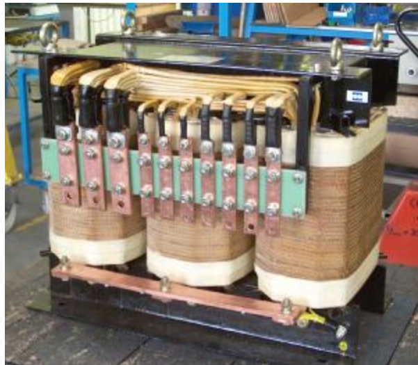
rys.6 Transformator prostownikowy 6 fazowy w układzie podwójnej gwiazdy.
